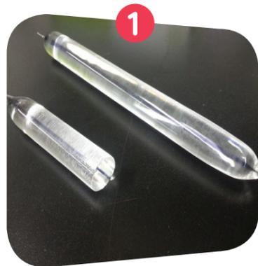
La fibre optique est créée à partir d'un **tube appelé « préforme »**. Ce tube est chauffé à **3200° C** pour former une **«goutte»** qui sera étirée sur 20m et **devient le fil de fibre** optique !
